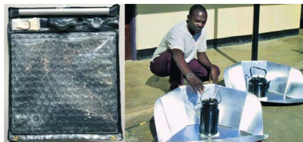
Figura 4. AquaPak frente a una solución local para la pasteurización solar
