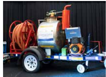
SADEWA DAPAT DITEMPATKAN DI DEKAT FASILITAS SPALDT PERMUKIMAN DAN DIISI DENGAN LIMBAH TINJA YANG DIPOMPAKAN OLEH PUSAKA.
