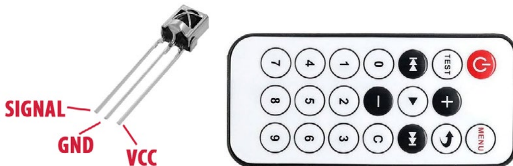
Slika pr5.4. Pinout HX1838 i izgled daljinskog upravljača
