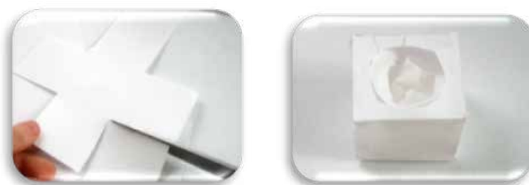
Slika 33. Izrada kućišta za RGB LED
