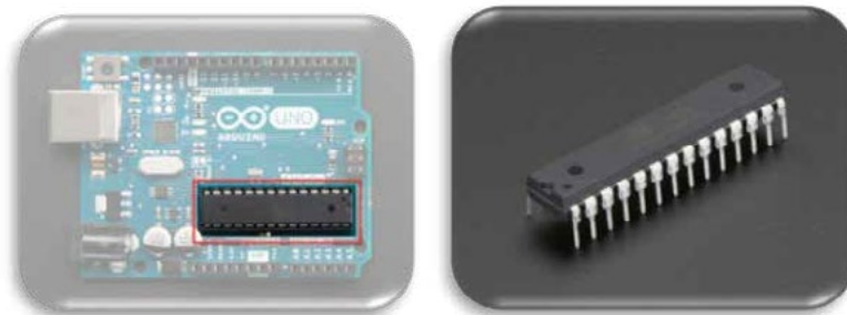
Slika 1. ATMEGA 328p na platformi Arduino i izvan nje
